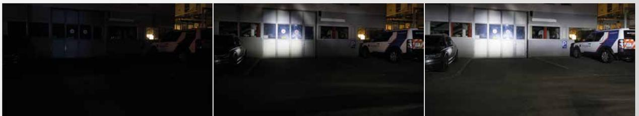
In den Eckmodulen oder nach vorne oder hinten kann mit Zweit- oder Drittfarbe weiß das Umfeld des Fahrzeuges beleuchtet werden. Doch auch bereits bei Blaulichtbenützung kann mit zusätzlichen Seitenlichtmodulen, z.B. nach Hausnummern, gesucht werden.
