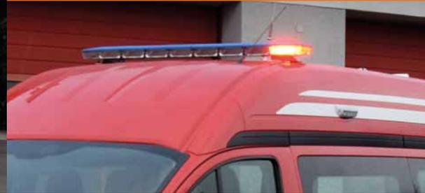
Anwendungsbeispiel: Das Blaulicht während der Einsatzfahrt wird zum Rotlicht für die Einsatzleitung vor Ort, 360° rundum sichtbar!
