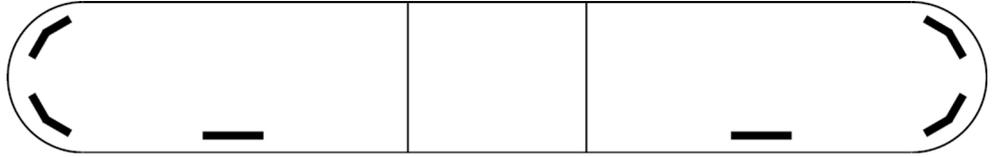
1 XPERT 4PRO-2PF, L=1089mm, 10-30VDC, Warn-u.Haubenfarbe Blau, Schild 300mm (12 o.24VDC)
