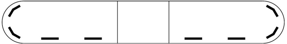
2 XPERT 4PRO-4PF, L=1229mm, 10-30VDC, Warn-u.Haubenfarbe Blau, Schild 300mm (12 o.24VDC)
