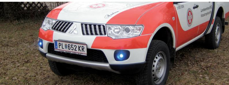
Mit einem Durchmesser von nur 29 mm ist die BL88 wahrscheinlich die kleinste ECE R65 zugelassene LED-Leuchte mit großer Lichtausbeute bei dennoch niedrigem Stromverbrauch.
