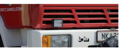
Großflächige LED-Blitzleuchte zum einfachen Aufrüsten bestehender Blink- oder Blitzleuchten auf die neueste LED-Technologie ohne die Kühlermaske tauschen oder bearbeiten zu müssen.
