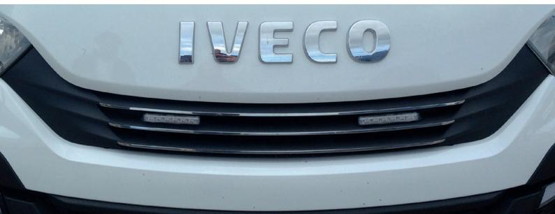
Nur 16mm hohe LED-Blitzleuchte mit 6x High-Power LEDs.
