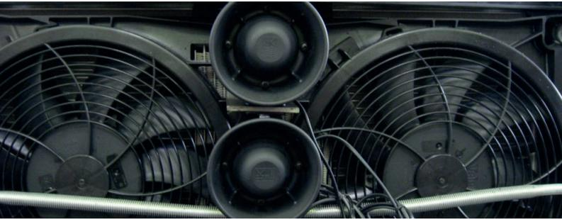
Kompakter Einbaulautsprecher in Neodymium-Technologie zum verdeckten Einbau für Eurosmart Elektroniksirene Gen2.2 (2 Stk. erforderlich), Eurosmart Compact ECO (1 Stk. erforderlich) oder Eurosmart Compact PRO (2 Stk. erforderlich)
