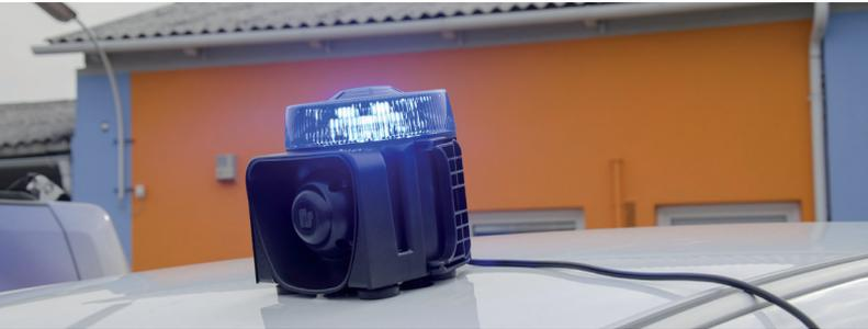
Die LM500 Solaris Serie kombiniert die Solaris Technologien LED-Kennleuchte und eine Kompaktsirene in einem Glasfaserverstärktem ABS-Kunststoff-Aluminiumgehäuse. Das optische System besteht aus der mikroprozessorgesteuerten Elektronik, 15 LEDs mit hoher Lichtintensität und einem parabolischem Reflektor, maximiert die Leuchtkraft der LEDs und vermeidet Schatten.
