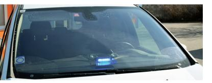
Für das Durchdringen Ihres Deckkennzeichen- oder Zivilfahrzeuges im dichten Verkehr oder für die Exekutive bei Durchsetzung von Anhaltungen von hinten, empfiehlt sich diese Warnleuchte. Die Befestigung an der Windschutzscheibe erfolgt mittels Saugnäpfen.
