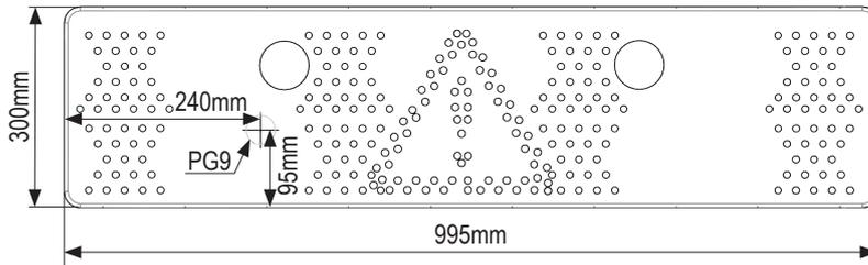
PG9-Verschraubung für Stromversorgung an der Rückseite.
