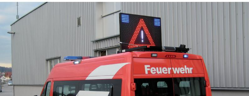
Funkferngesteuertes, motorisch klappbares LED-Panel zur Absicherung des Einsatzortes bereits über größte Entfernungen hinweg. Für Polizei, Feuerwehr, Straßendienst u. a.
