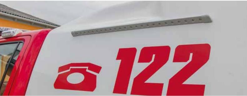
Dieser 24 LED-Strip mit neuester LED-Technologie bietet einen Lichtstrom von 2000 Lumen bei einem Abstrahlwinkel von 120°.
